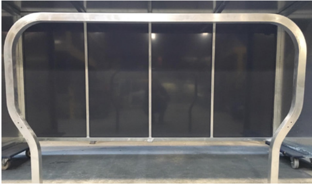
PRODUKT „Panther - Rosenbauer“ Dornbiegen von Vierkantrohren sowie Zuschnitt und Fräsung für Absturzsicherungen auf Löschfahrzeugen.
