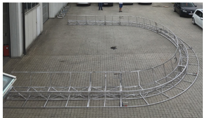
PROJEKT „Salzburger Festspiele“ Komplettfertigung eines Torbogens und des Teufelrades aus Aluminium und Stahl. Rollbiege-, Dornbiege- und Schweißkonstruktionen.
