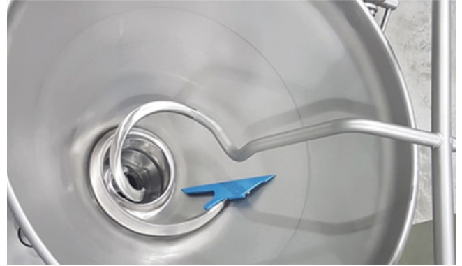
PRODUKT „Gegenstopperrohr“ Dornbiegen eines dickwandigen Edelstahlrohres für die Lebensmittelindustrie.
